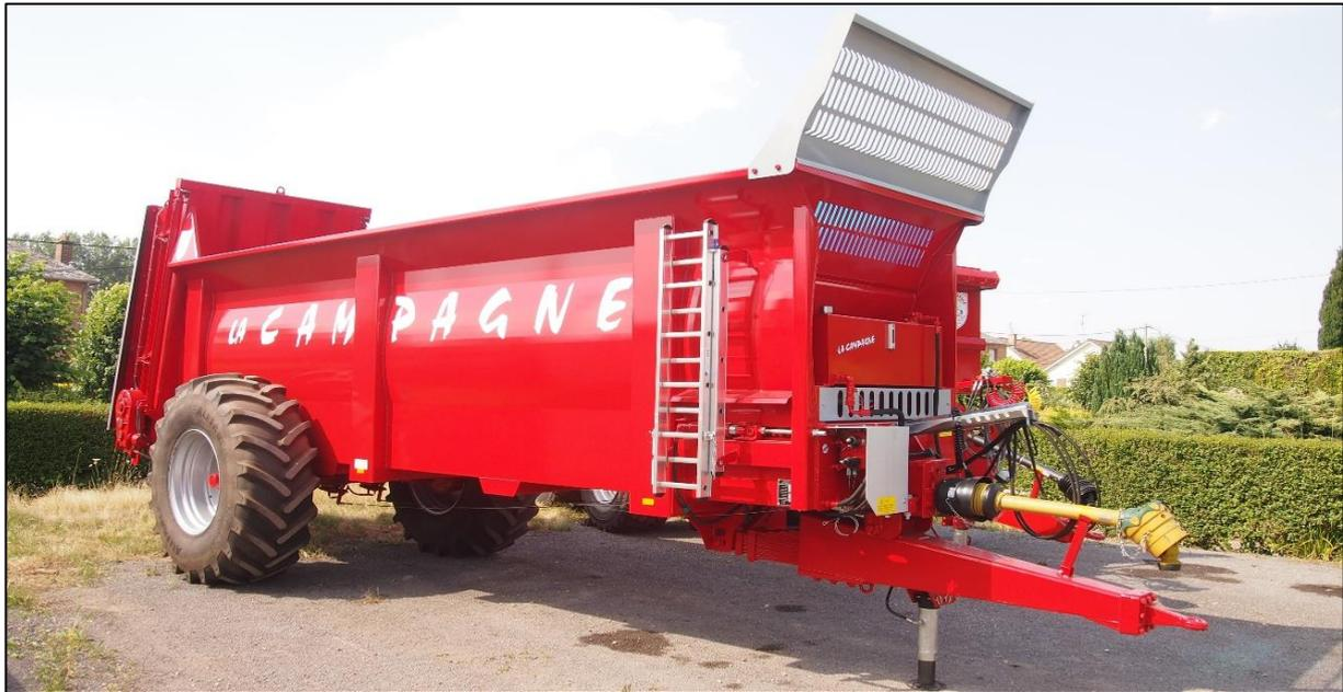
**Flèche réglable en hauteur avec suspension à ressort 15 lames, cric hydraulique repliable avec pompe à main, freinage hydraulique, cardan homocinétique Pare-chocs avec feux LED protégés et gyrophare**
