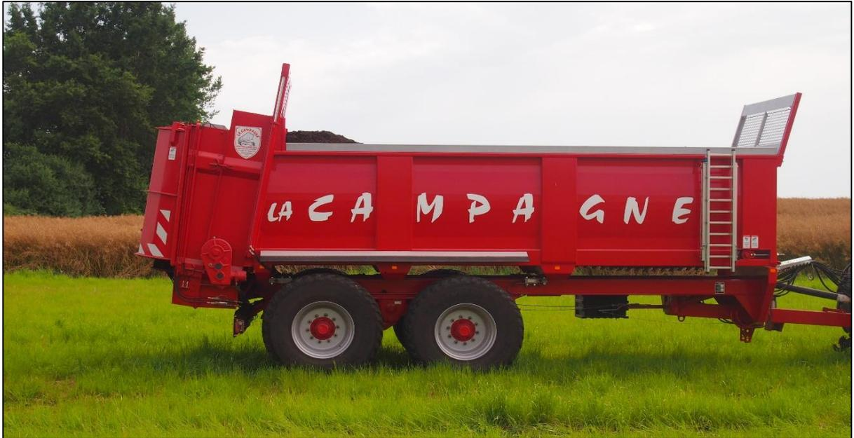
**Châssis en tube 200 x 100 Flèche réglable en hauteur avec ressort, cric hydraulique repliable avec pompe à main.**
