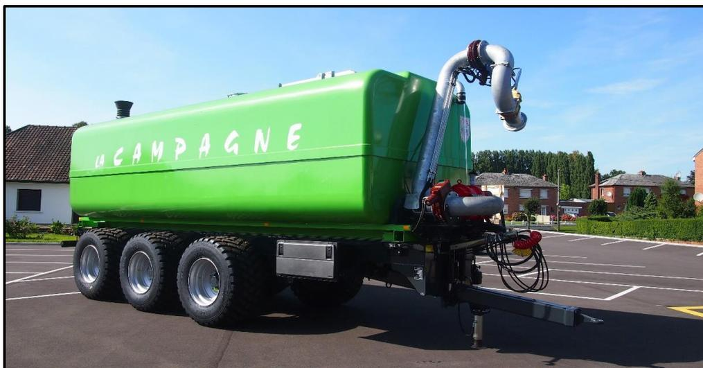
**CHASSIS :** Tube 300x200 Flèche à Cillet boulonné ou K80? Suspension de flèche hydraulique Cric hydraulique avec pompe à main TRIDEM CARRE 130 lames plates (10 lames de 15mm dont 4 lames maitresses) Freins 406 x 140 / freinage pneumatique + correcteur de freinage suiveur arrière double effet avec indicateur de blocage : essieux avant et arrière Barre anti encastrement arrière Double Feux LED et feux de gabarits Roues 445x65R22,5 Profil Routier
