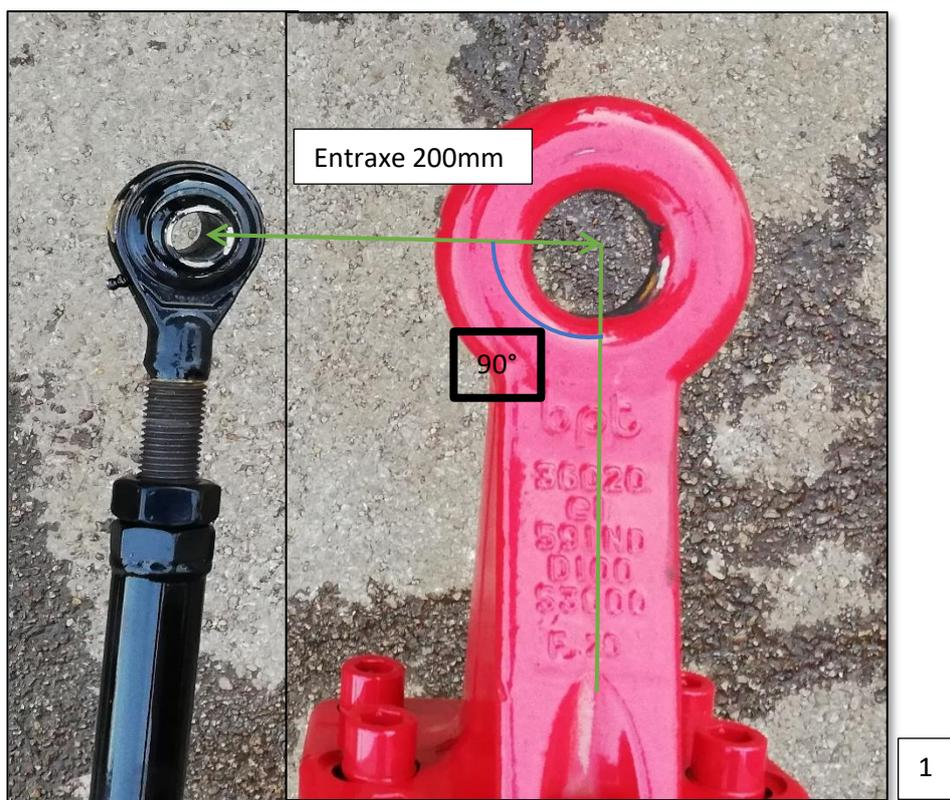
Les cotes les plus importantes pour la mise en place de la chape sur le tracteur sont l'entraxe de 200 mm et l'alignement des deux axes (voir photo)
